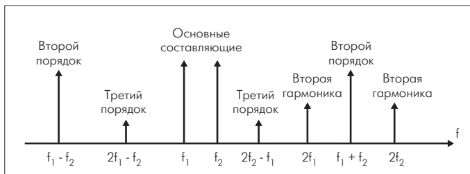
Рис. 1. Спектр интермодуляционных продуктов при двухчастотном входном сигнале
